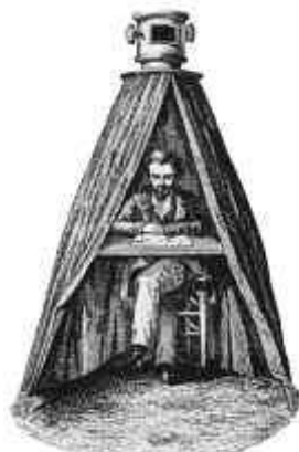
Câmara Escura em forma de tenda utilizada por Johann Kepler 1620
