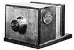
Câmara de daguerreotipia com o monograma de Daguerre - 1839 (reconstituição)
